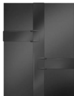
Avec des longueurs décalées, il est possible de recouvrir les membranes Prelasti si nécessaire, même si nous recommandons de garder les membranes soudées bord à bord lorsque l'on utilise la technique de soudure Thermobond.
