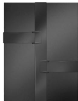
Wenn Prelasti mit gestaffelten Längen verlegt wird, ist eine Überlappung der Prelasti Planen möglich, auch wenn wir eine stumpf gestoßene Verlegung empfehlen, bei Anwendung von Thermobond Verschweißung.
