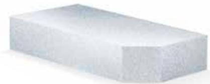
Bei einem Dach mit Auflast muss die Dämmung dem ständigen Druck gewachsen sein und dem Gewicht der einzelnen Konstruktionen standhalten können. Wir benötigen ein Minimum an Druckfestigkeit bei einer 10%igen Deformation von 60 kPa (60 kN/m<sup>2</sup>) um eine einwandfreie Verlegung zu gewährleisten.
