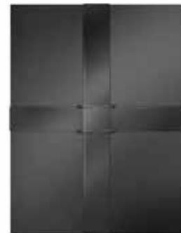
Falls Prelasti wie ein Gitter mit vier Planen verlegt werden soll, müssen die vier aufeinander treffenden Ecken der Plane ohne Überlappung miteinander verbunden werden. Der untere Thermobond R Schweißstreifen muss mit der Schweißschnur am Kreuzungspunkt des oberen Streifens versiegelt werden, um Höhenunterschiede auszugleichen. Die Thermobond Schweißschnur muss so aufgetragen werden, dass diese mindestens 10 mm unter dem darunter liegenden Streifen bedeckt ist.
