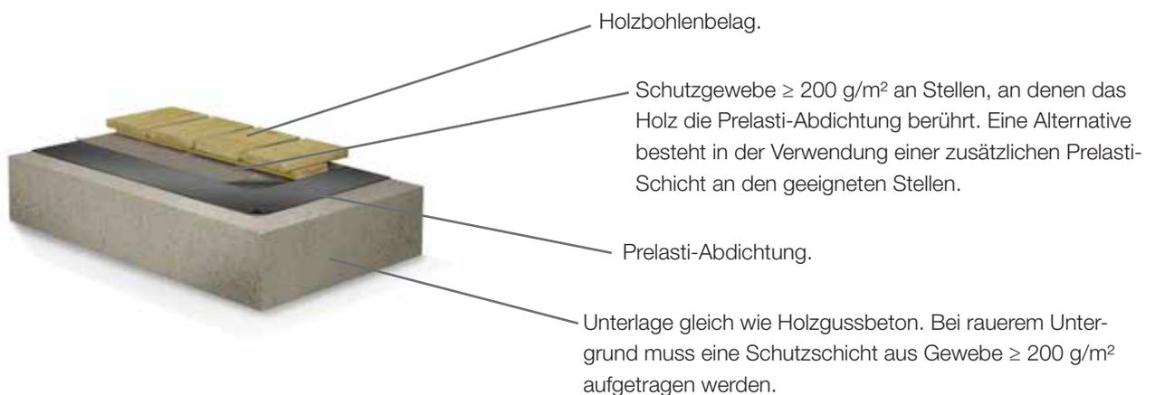
**Hinweis!** Stellen Sie sicher, dass Sie für den Holzbohlenbelag die richtige Belastung kontrollieren und verlegen. Berücksichtigen Sie dabei, dass die Dichte des Holzes selbst nicht zur Gewährleistung einer einwandfreien Fixierung ausreichen könnte. Der Holzbohlenbelag sollte behandelt und mit Holzöl geschützt werden. Über der Prelasti-Abdichtung muss eine Schutzschicht, wie eine Polyethylen-Folie, vorhanden sein, um eine chemische Beschädigung zu vermeiden.
