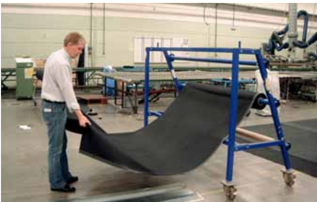
Positioneringen av duken underlättas om utrullningsutrustningen roteras ett helt varv.
