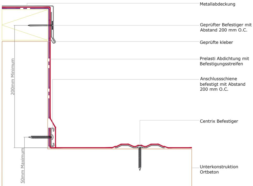
**PRE-021 Attika Detail für ein nicht belüftetes Dach – Centrix mechanisch fixiert – Option 2**
