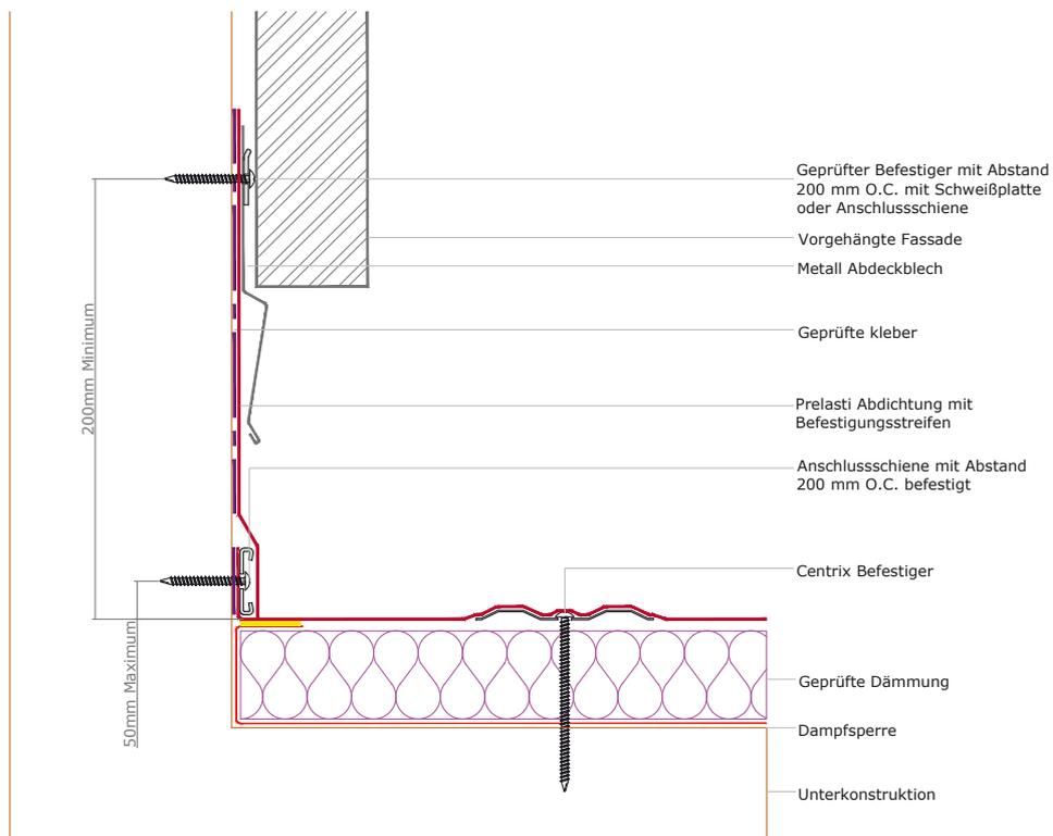
**PRE-602**      **Verbindungsstruktur zwischen zwei Abdichtungen für ein nicht belüftetes Dach – Centrix mechanisch fixiert**
