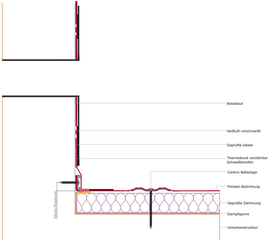
**PRE-317 Überlauf Detail für ein belüftetes Dach – Centrix mechanisch fixiert**
