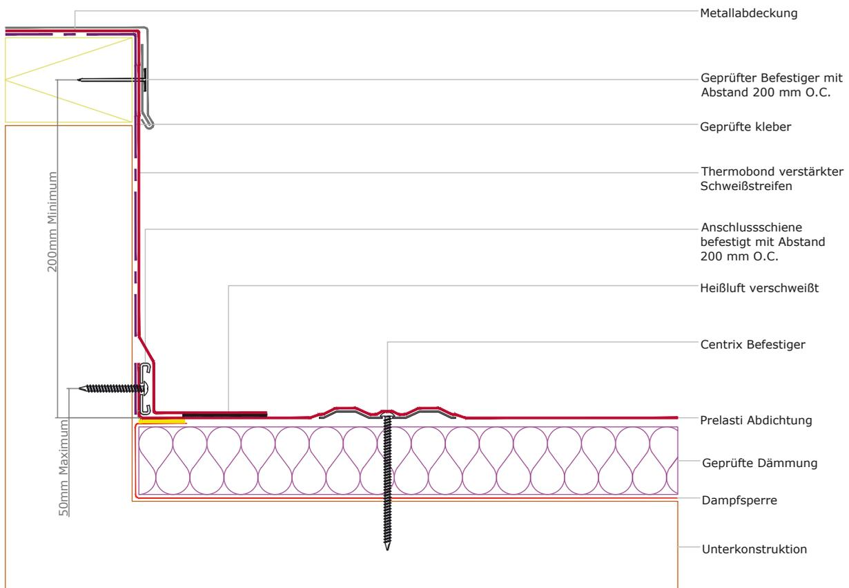
**PRE-020 Attika Detail für ein belüftetes Dach – Centrix mechanisch fixiert – Option 2**
