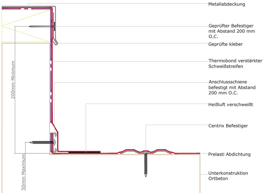
**PRE-019 Attika Detail für ein nicht belüftetes Dach – Centrix mechanisch fixiert**
