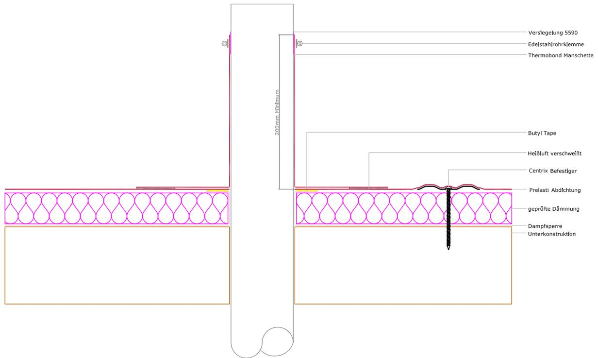
**PRE-209 Rohr Detail für ein belüftetes Dach – Centrix mechanisch fixiert**
