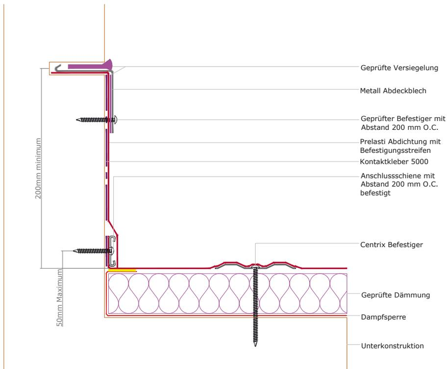
**PRE-508 Wandanschluss Schiene für ein nicht belüftetes Dach – Centrix mechanisch fixiert – Option 2**
