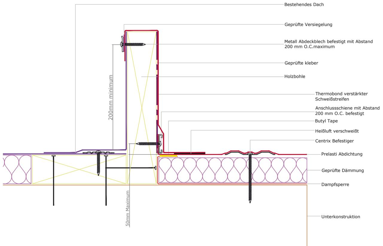
**PRE-603**      **Kehlen Detail für ein nicht belüftetes Dach – Centrix mechanisch fixiert**
