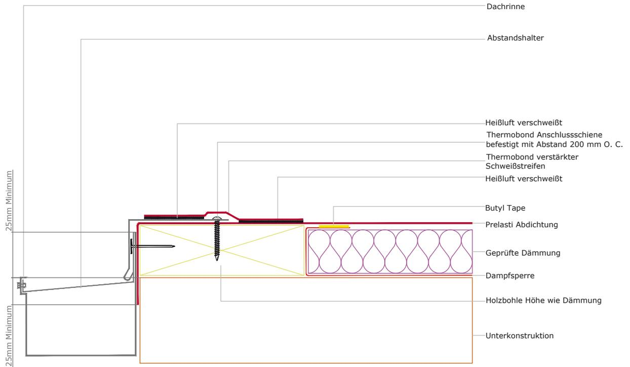
**PRE-208 Rohr Detail für ein nicht belüftetes Dach – Centrix mechanisch fixiert**
