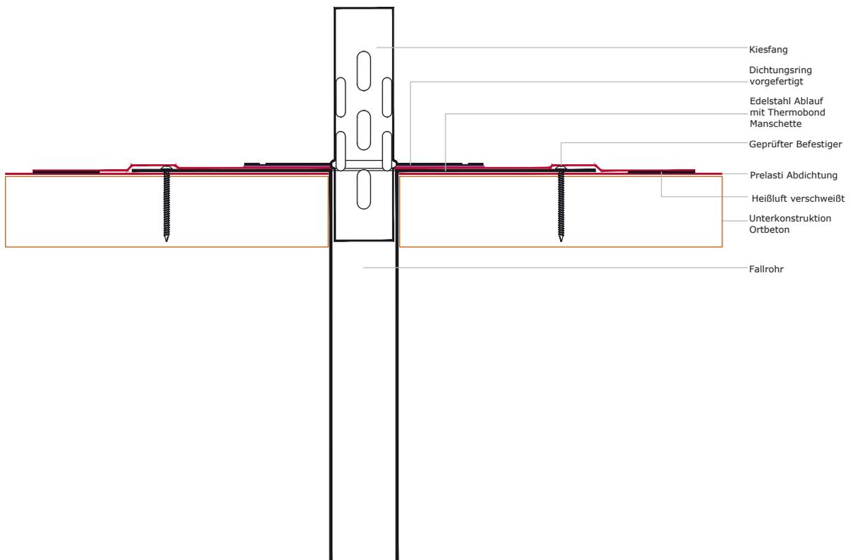
**PRE-316 Überlauf Detail für ein nicht belüftetes Dach – Centrix mechanisch fixiert**
