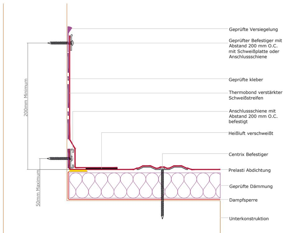
**PRE-506 Anschluss hinter vorgehängter Fassade – Centrix mechanisch fixiert**
