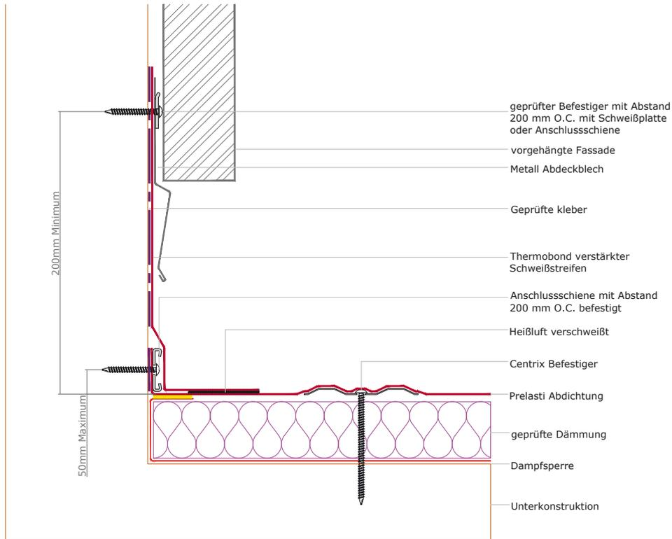
**PRE-507 Eingelassenes Abdeckblech für ein nicht belüftetes Dach – Centrix mechanisch fixiert - Option 2**
