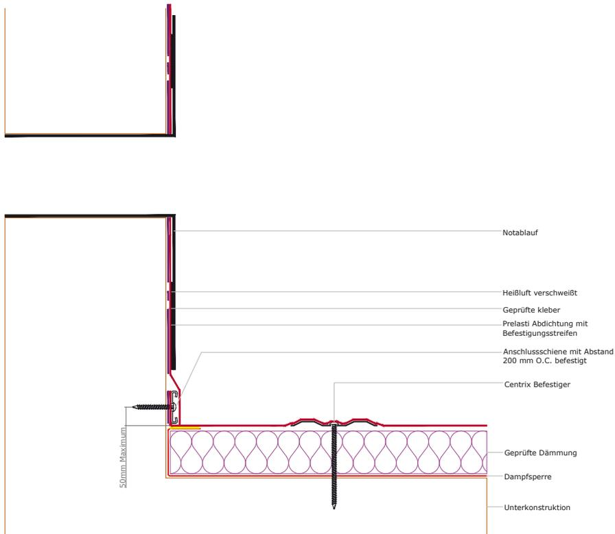
**PRE-319**      **Überlauf Detail für ein belüftetes Dach – Centrix mechanisch fixiert – Option 2**
