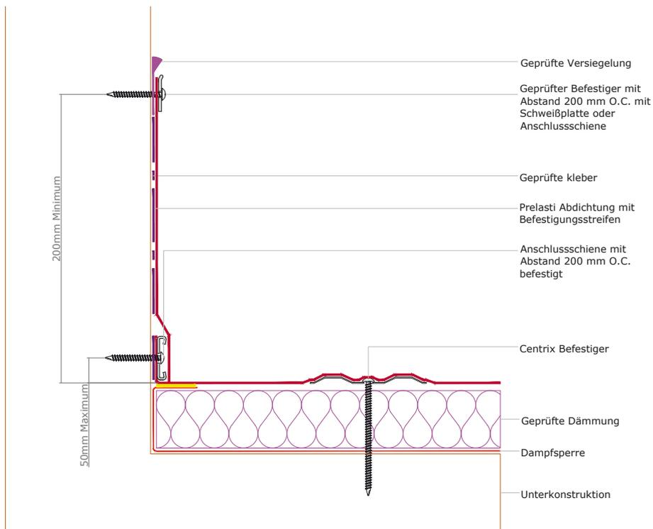
**PRE-509 Anschluss hinter vorgehängter Fassade – Centrix mechanisch fixiert - Option 2**
