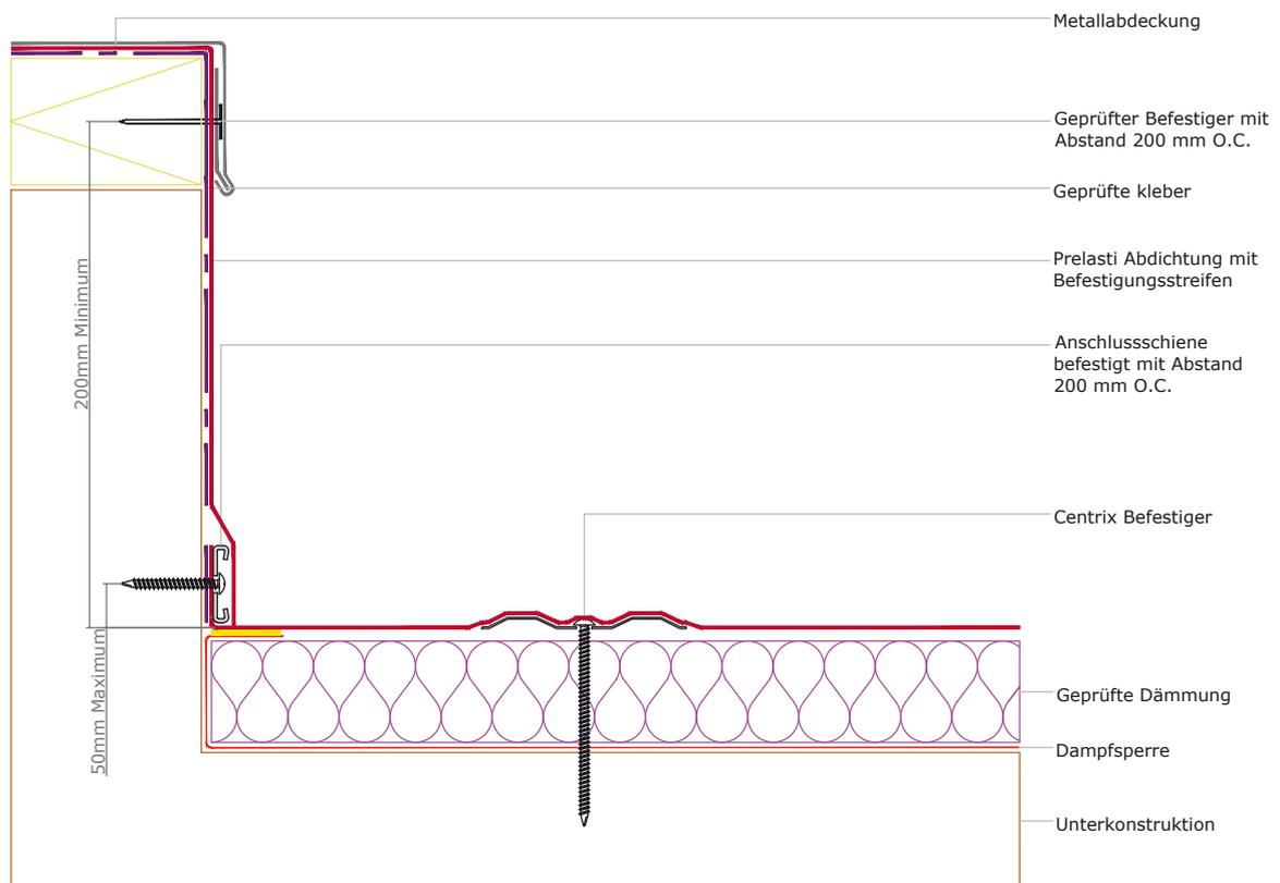
**PRE-101 Tropfkanten Detail für ein nicht belüftetes Dach – Centrix mechanisch fixiert**
