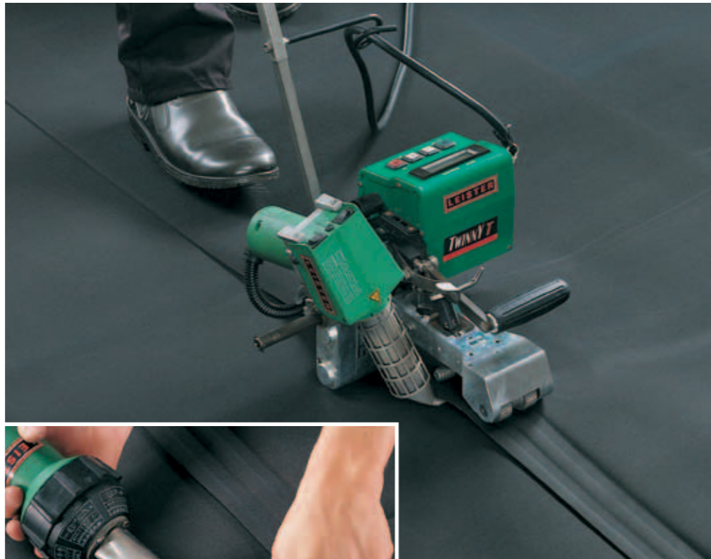
Naden met druktest worden vervaardigd met aangepaste lastoestellen. Kanaallasmachines bieden de mogelijkheid de naad te testen onder druk en dit zowel ogenblikkelijk als na vele jaren.
