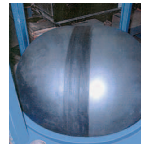
Testen van multi-axiale sterkte volgens ASTM D 5617 op Elastoseal met een thermobondnaad.
