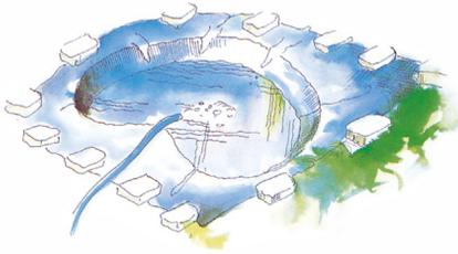
**3.** Durch das Gewicht des Wassers gleitet die Folie hinab und passt sich perfekt den Konturen der Grube an. Wenn der Teich gefüllt ist, schneiden Sie die Überhänge der Greenseal Folie bis auf 20-40cm ab. Befestigen Sie die Ränder mit Steinen oder Betonplatten oder verankern Sie die Seiten alternativ in einer 30x30cm Furche und füllen Sie diese auf. Lassen Sie den Teich einige Tage ruhen, bevor Sie mit der Bepflanzung beginnen.
