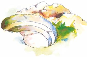
**1.** Entfernen Sie scharfe Steine und Wurzeln und geben Sie eine Lage Sand auf den Boden des Teichbetts. Alternativ kann alternativ kann ein Vlies mit einer Dicke von 150g/qm ausgelegt werden. Um eine abwechslungsreiche Vegetation zu erreichen, können Sie rund um den Teich Vertiefungen anlegen.
