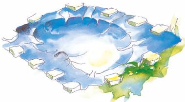
**2.** Überprüfen Sie die Grube noch einmal auf scharfe Steine und Wurzeln und legen Sie Sand oder das Vlies aus. Legen Sie die Grube mit der Greenseal Teichabdichtungsbahn aus und fixieren Sie die Folie an den Rändern mit einigen Steinen. Füllen Sie Wasser ein.
