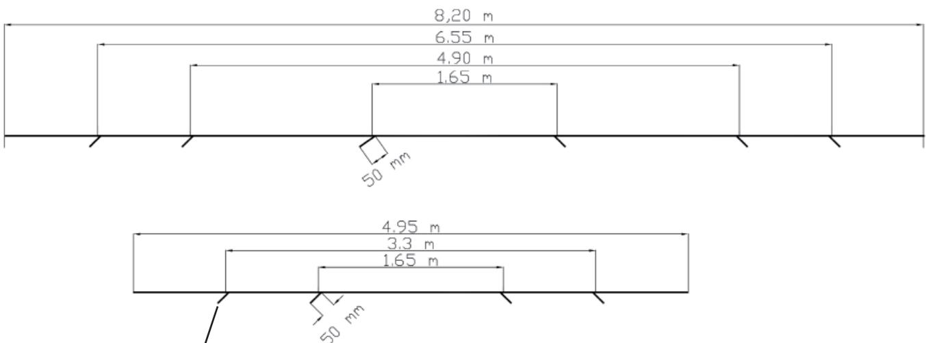
Die Laschen der Plane sind 50 mm breit und können mit den 40 mm breiten Befestigungsscheiben und passenden Senkschrauben befestigt werden. Die Schraube sollte in der Mitte der Lasche eingesetzt werden. Nach der Montage liegt die Plane flach auf dem Untergrund.
