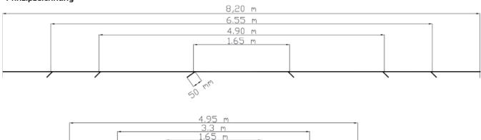
Die Laschen am Plane sind 50 mm breit und können mit den 40 mm breiten belastbaren Platten und passenden Senkschrauben befestigt werden. Die Schraube sollte in der Mitte der Lasche eingesetzt werden. Nach der Montage liegt die Plane flach auf der Untergrund.
