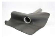
L'**Avaloir RubberShell PC** est prévu d'une bavette RubberShell SA-FR 500 x 500 mm à souder à l'air chaud sur la membrane. La buse est en acier inoxydable. La longueur de la buse est de 500 mm.
