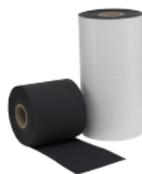
Le **Thermobond Splice Strip (Non-reinforced)** est utilisé pour sceller les formes plus rondes telles que les pénétrations de tuyaux, les pièces plus rondes telles que les pénétrations de tuyaux, les pièces de drainage, etc. Ce matériau n'est pas renforcé et donc également déformable. Il se compose d'une couche d'EPDM et d'une couche inférieure de Thermobond, qui peut être thermosoudé.
