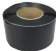
**Flashing Tape** est utilisé pour la finition des détails comme les passages, les coins, les joints-T sur les membranes EPDM de SealEco. Le produit est doux et flexible. Il procure une adhésion immédiate au contact de la membrane sans temps de durcissement supplémentaire. Le Flashing Tape est toujours utilisé en combinaison avec le Single Ply Primer.
