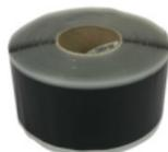
**Cover Tape** est utilisé pour relier et étanchéifier les membranes en EPDM de SealEco. Le ruban adhésif peut également être utilisé pour les réparations, les ajustements et pour les finitions des détails. Le produit est doux et flexible. Il procure une adhésion immédiate au contact de la membrane sans temps de durcissement supplémentaire. Le Cover Tape est toujours utilisé en combinaison avec le Single Ply Primer.
