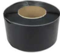
**Flashing Tape** (Dichtband) wird zum Abdichten von Details, Ecken, Rohren und T-Verbindungen auf SealEco-Membranen verwendet. Das Dichtband bietet sofortige Haftung, ist extrem flexibel und kann so geformt werden, dass unregelmäßige Details abgedichtet werden. Dichtband sollte immer in Kombination mit Single Ply Primer verwendet werden.
