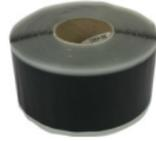
Abdeckband wird den Anschluss und zum Verbinden von SealEco EPDM-Membranen verwendet. Abdeckband wird hauptsächlich zum Spleißen von mechanisch befestigten Membranen, zur Befestigung von Dachrandverkleidungen, für Reparaturen und Details verwendet. Cover Tape ist flexibel und bietet sofortige Haftung bei Kontakt mit der Membran. Das Produkt sollte immer in Kombination mit Single Ply Primer verwendet werden.
