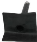
Der **Reinforced Perimeter Strip** wird als Basisanschluss für unbeschichtete EPDM Dachmembranen von SealEco verwendet. Der verstärkte EPDM-Streifen ist teilweise mit einem Nahtband beschichtet und bietet sofortige Haftung auf der EPDM-Membran. Der Reinforced Perimeter Strip sollte immer verwendet werden in Kombination mit Single Ply Primer.
