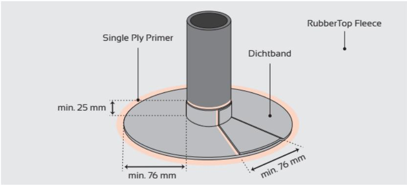
4. Schneiden Sie ein zweites Stück ab, das die horizontale Dichtbasis mindestens 50 mm überlappt. Die Höhe muss 150 mm über der schlussendlichen Dachhöhe betragen. Grundierung auftragen, warten bis abgelüftet. Bringen Sie das Dichtband an. Tragen Sie Single Ply Primer auf die Überlappung auf. Warten Sie, bis es abgelüftet ist, schließen Sie es und rollen Sie es fest. Abschließend alle Spleiße und Verbindungen mit Sealant 5590 abdichten.
