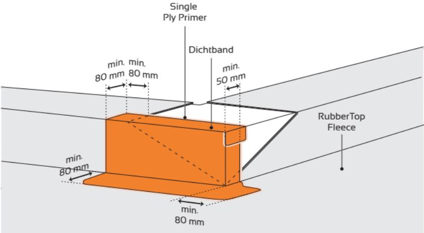
3. Befolgen Sie die nächsten Schritte zum Aufkleben des Dichtbands der Reihenfolge nach. Vergessen Sie nicht, den Single Ply Primer aufzutragen, die offene Zeit einzuhalten und Stück für Stück mit einer 40 mm Silikon- und Messingrolle anzudrücken. Verteilen Sie die Beanspruchungen gleichmäßig, während Sie das Dichtband dehnen. Alle Nähte mit Sealant 5590 sichern.
