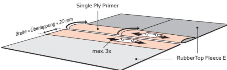
Installieren Sie das Nahtband mit der Trennfolie nach oben. Richten Sie die Trennfolie so aus, dass die minimale Überlappung gewährleistet ist. Rollen Sie das Nahtband ab. Rollen Sie es mit einer 40 mm Silikonrolle auf, ohne Luft einzuschließen.
