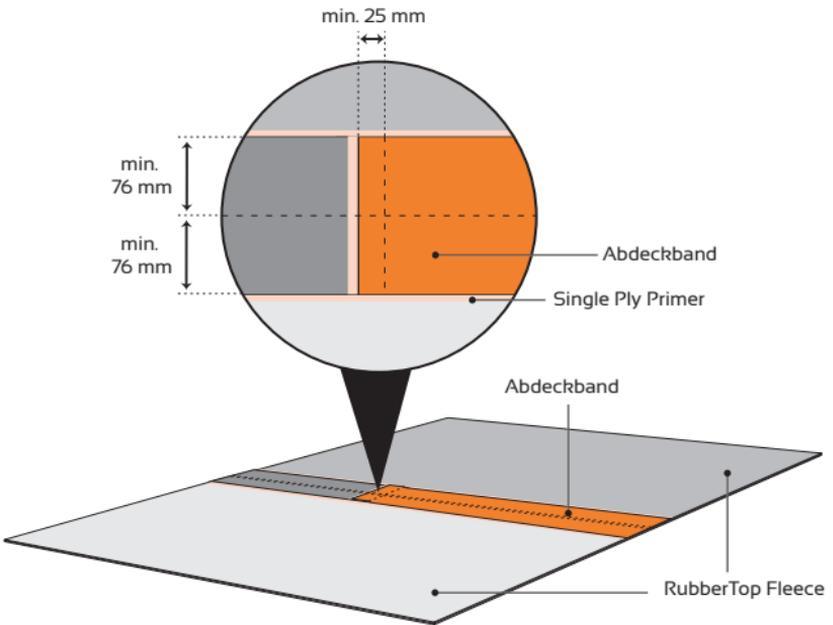
Schneiden Sie ein Stück Dichtband wie in der nächsten Abbildung gezeigt ab. Tragen Sie Single Ply Primer auf den Spleißbereich auf und bringen Sie das Dichtband an. Mit einer 40 mm breiten Silikonrolle aufrollen. Alle T-Verbindungen zusätzlich mit einer Messingrolle rollen. Befestigen Sie den Patch mit Sealant 5590.
