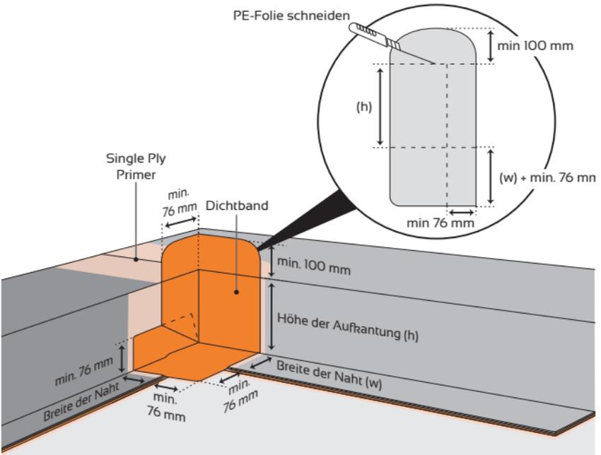
4. Befolgen Sie die nächsten Schritte zum Aufkleben des Dichtbands der Reihenfolge nach. Vergessen Sie nicht, den Single Ply Primer aufzutragen, die offene Zeit einzuhalten und Stück für Stück mit einer 40 mm Silikon- und Messingrolle anzudrücken. Verteilen Sie die Beanspruchungen gleichmäßig, während Sie das Dichtband dehnen.
