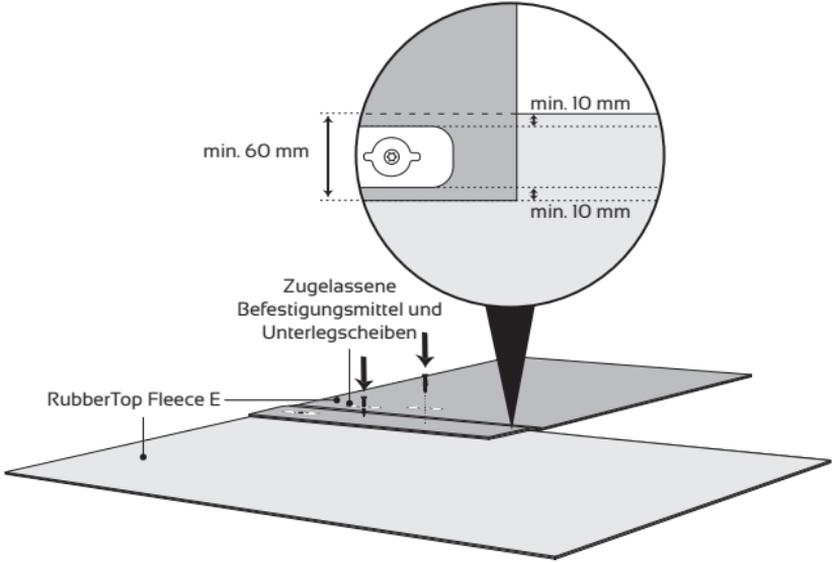
Wenn Sie zwei Rollen aneinanderreihen, richten Sie diese in einer geraden Linie aus und befestigen Sie sie in der Überlappung, wie in der Abbildung unten gezeigt. Bringen Sie im Abstand von min. 90 mm an beiden Seiten der Unterlegscheiben Markierungen an.
