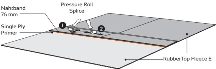
Positionieren Sie das Abdeckband von mindestens 152 mm mit einer Mindestüberlappung von 76 mm auf jeder Platte, wie unten gezeigt. Ziehen Sie eine Linie 10 - 15 mm vom Rand des Abdeckbandes und rollen Sie es zurück. Tragen Sie den Single Ply Primer auf den gesamten Spleißbereich auf. Nach dem Ablüften bringen Sie das Abdeckband an, indem Sie die Schutzfolie entfernen und gleichzeitig auf das Abdeckband drücken. Rollen Sie die Naht mit einer Silikon-Andruckrolle wie zuvor beschrieben auf.
