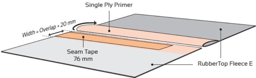
Das angrenzende Nahtband wird mit einer Überlappung von mindestens 25 mm abgerollt. Die Überlappung darf nicht grundiert werden! Reißen Sie nur die Trennfolie ab, wo sich die Bänder überlappen.
