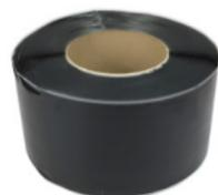
**Flashing Tape** (Dichtband) wird zum Abdichten von Details, Ecken, Rohren und T-Verbindungen auf SealEco-Membranen verwendet. Das Dichtband bietet sofortige Haftung, ist extrem flexibel und kann so geformt werden, dass unregelmäßige Details abgedichtet werden. Dichtband sollte immer in Kombination mit Single Ply Primer verwendet werden.
