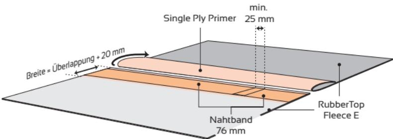
Schließen Sie die Überlappung. Jetzt die Schutzfolie entfernen, die Überlappung mit den Händen zusammenfügen und mit einer Silikonrolle rollen. Zuerst über die Naht und danach in der Länge der Naht. Zu jeder Zeit müssen 5-15 mm Klebeband sichtbar sein.
