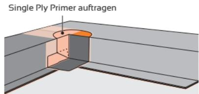
5. Bereiten Sie zwei zusätzliche Dichtpatches vor, wie in der Abbildung gezeigt. Tragen Sie den Single Ply Primer auf, lassen sie es ablüften und kleben Sie die restlichen Dichtbandstücke gemäß der Abbildung unten an.
