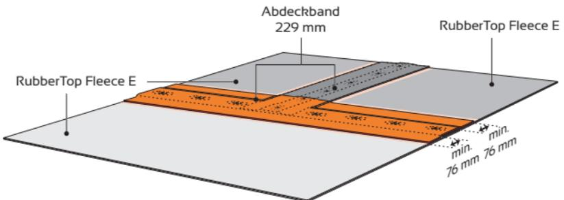
Um eine Kapillarwirkung zu verhindern, werden T-Verbindungen mit einem Dichtband gesichert. Schneiden Sie ein Dichtband wie in der nächsten Abbildung erklärt zu. Positionieren Sie den Patch, ziehen Sie eine Linie im Abstand von 10 - 15 mm vom Rand des Patch. Tragen Sie Single Ply Primer auf, lassen Sie ihn abgelüften und installieren Sie den Dichtband-Patch.
