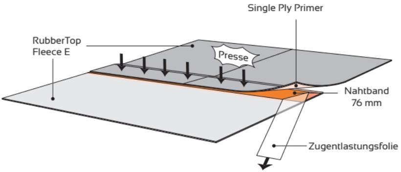
Rollen Sie die Naht mit einer Silikon-Andruckrolle von 40 mm auf. Zuerst quer zur Naht, um Luftpneinschlüsse zu vermeiden, und danach in der Länge der Naht. 5-15 mm Klebeband müssen immer sichtbar bleiben. Wenn nicht, muss zur Reparatur ein Dichtband darüber gespleißt werden.
