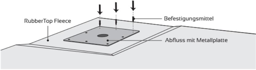
3. Mit Dichtband spleißen und mit Sealant 5590 abdichten.
