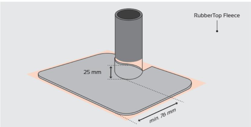
2. Sorgen Sie dafür, dass eine Überlappung von mindestens 76 mm entsteht. Tragen Sie einen Single Ply Primer auf. Ablüften lassen. Installieren Sie das Dichtteil wie unten gezeigt.
