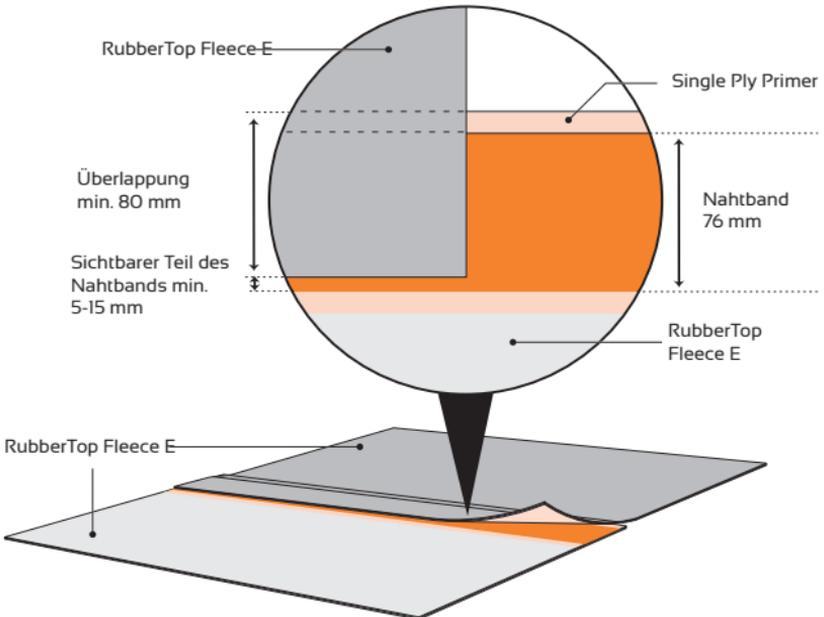
Nach der Positionierung der Rolle RubberTop Fleece E die zweite mit einer Überlappung von mindestens 80 mm abrollen. Wenn Sie zwei Rollen zusammenfügen, richten Sie sie in einer geraden Linie aus und legen Sie sie bis zum Ende ab. Beginnen Sie zuerst mit dem Spleißen der Überlappungen und fahren Sie dann mit den Kreuzspleißen fort, wobei Sie ein Abdeckband von mindestens 152 mm verwenden.
