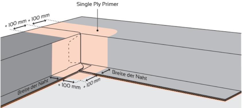
3. Bereiten Sie ein Stück Dichtband vor, das in der Ecke gefaltet werden kann, wie in der nächsten Abbildung gezeigt. Um die Installation zu erleichtern, empfehlen wir, die Trennfolie wie abgebildet zuzuschneiden.
