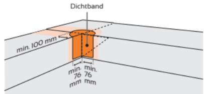
2. Tragen Sie Single Ply Primer auf das Dichtband auf und lassen Sie es abtrocknen. Bringen Sie abschließend das Dichtband wie unten gezeigt an der Dachkante an. Alle Nähte mit Sealant 5590 sichern.
