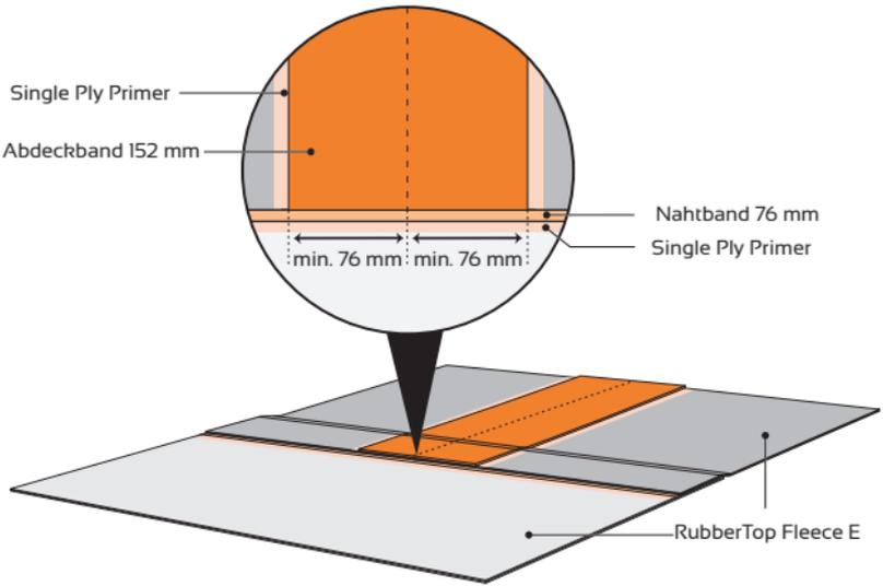
Um eine Kapillarwirkung zu verhindern, werden T-Verbindungen mit einem Dichtband gesichert. Schneiden Sie ein Dichtband wie in der Abbildung unten beschrieben ab. Positionieren Sie den Patch, ziehen Sie eine Linie 10 - 15 mm vom Rand des Patch. Tragen Sie Single Ply Primer auf, lassen Sie ihn ablüften und installieren Sie den Dichtband-Patch. Rollen Sie mit einer Silikonrolle wie zuvor beschrieben. T-Kanten auch mit Messingrolle rollen. Sichern Sie das Dichtband mit Sealant 5590.
