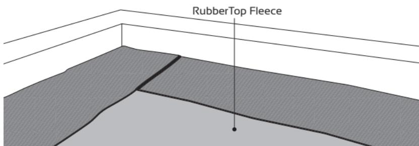
2. Tragen Sie auf die Oberfläche der Aufkantung, der Dachkante und auf die Membran einen geeigneten Kleber auf. Kleben Sie ihn beim Ablüften auf. Mit einer Silikon-Andruckrolle aufrollen.
