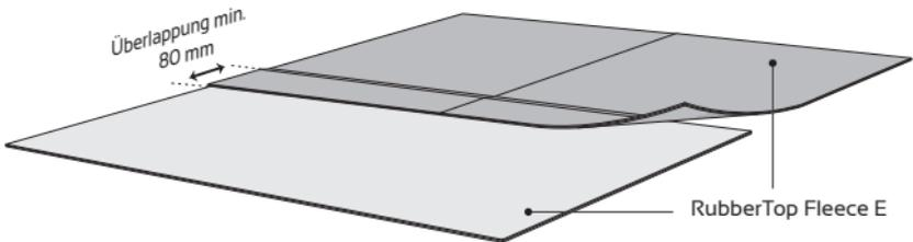
Falten Sie die Überlappung (E-Kante) zurück und halten Sie sie in Position. Tragen Sie den Single Ply Primer gemäß den Anweisungen auf beide Oberflächen auf.
