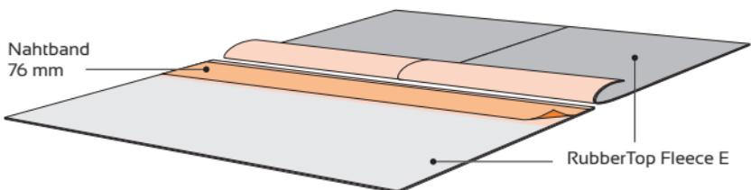
Schließen Sie die Überlappung und entfernen Sie die Trennfolie, indem Sie sie in einem Winkel von 45° abziehen, wie in den nächsten Abbildungen gezeigt. Halten Sie die Trennfolie dicht an der Dachoberfläche, um Lufteinschlüsse zu vermeiden. Drücken Sie die Überlappung von Hand, um Falten beim Aufrollen der Naht zu vermeiden. Vermeiden Sie Lufteinschlüsse zwischen Nahtband und RubberTop Fleece E Überlappung.
